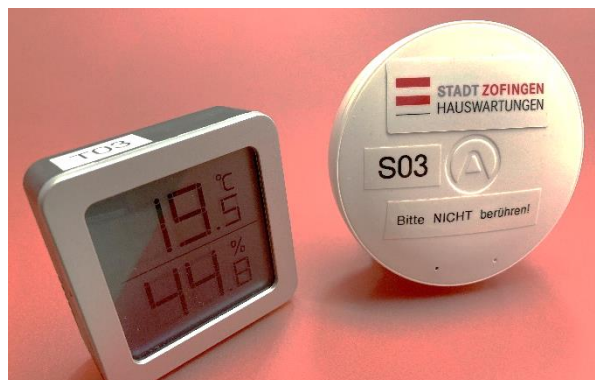
Die Aufzeichnung und Fernablesung mittels 82 Temperatursensoren ist Voraussetzung für die Optimierung der komplexen Heizungsanlagen in den Altbauten.
