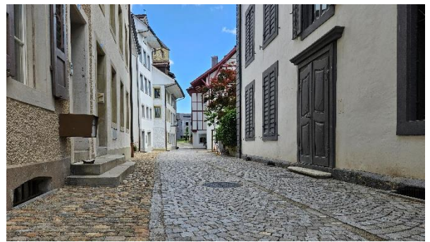
Ringmauergasse mit den behindertengerechten Pflastersteinen im Strassenbereich
