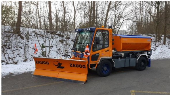
Allrad-Kommunalfahrzeug Meili 7000 mit Zaugg-Schneepflug und Doppelschnecken-Streugerät
